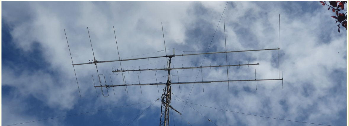
Mis antenas con la Yagi LFA de 11 elementos
